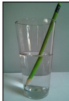
Figura 1. Refracción de la luz, que provoca que el lápiz se observe doblado, en la interfaz entre el aire y el agua.
